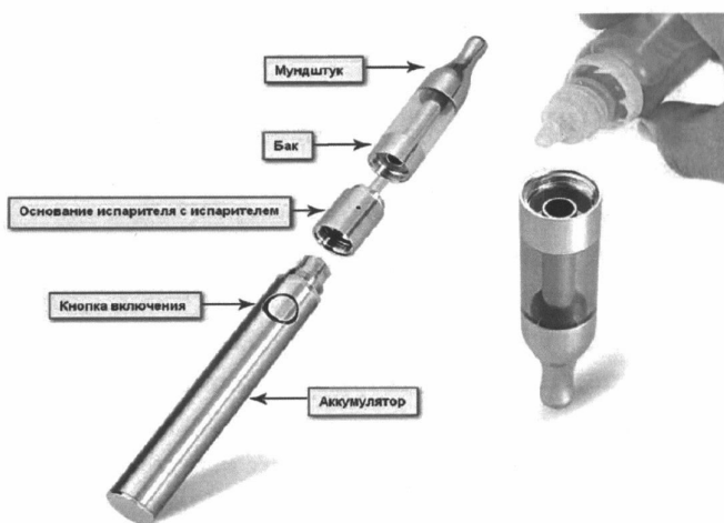
Рис. 3. Устройство электронной сигареты
